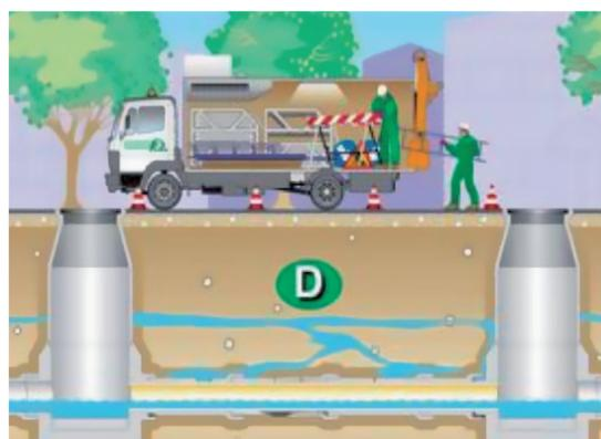
Rivestimento effettuato rispettando il diametro originario della condotta.
